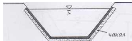
Слика 3.8. Канал со асфалтбетонска облога
